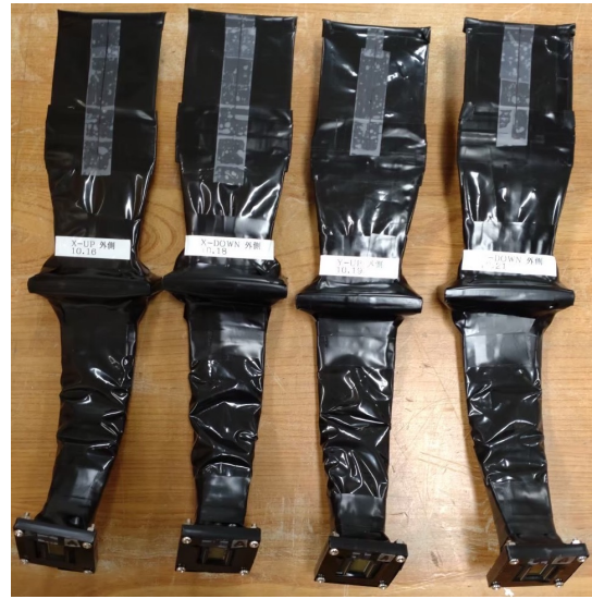
(b) UP/DOWN の outer layer に使用したファイバートラッカーは合計で 4 台製作した.
