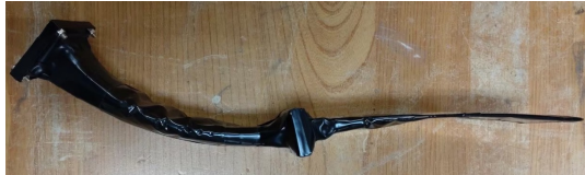
(a) UP/DOWN の outer layer に使用したファイバートラッカー. 写真は遮光後のもので, 黒いビニールシートの内側には 64 本のプラスチックシンチレーションファイバーが 1 列に並んでいる.
