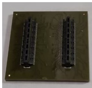
(b) MPPC array の接続面の写真. 1 対のフラットケーブルにより、信号読み出し/電圧印加用モジュール EASIROC に接続する。
