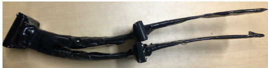
(a) UP/DOWN の inner layer に使用したファイバートラッカー. 写真は遮光後のもので, 黒いビニールシートの内側には 32 本のプラスチックシンチレーションファイバーが 2 列に並んでいる.
