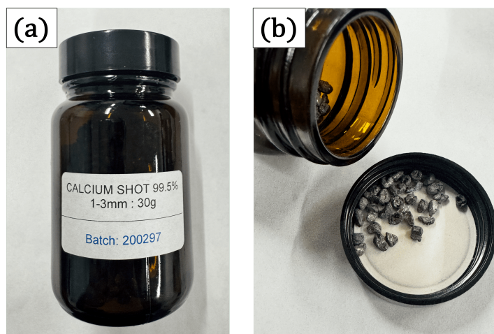
図 6.2: 金属 Ca 試料。(a) 金属 Ca 試料封入瓶、(b) 粒状の金属 Ca
