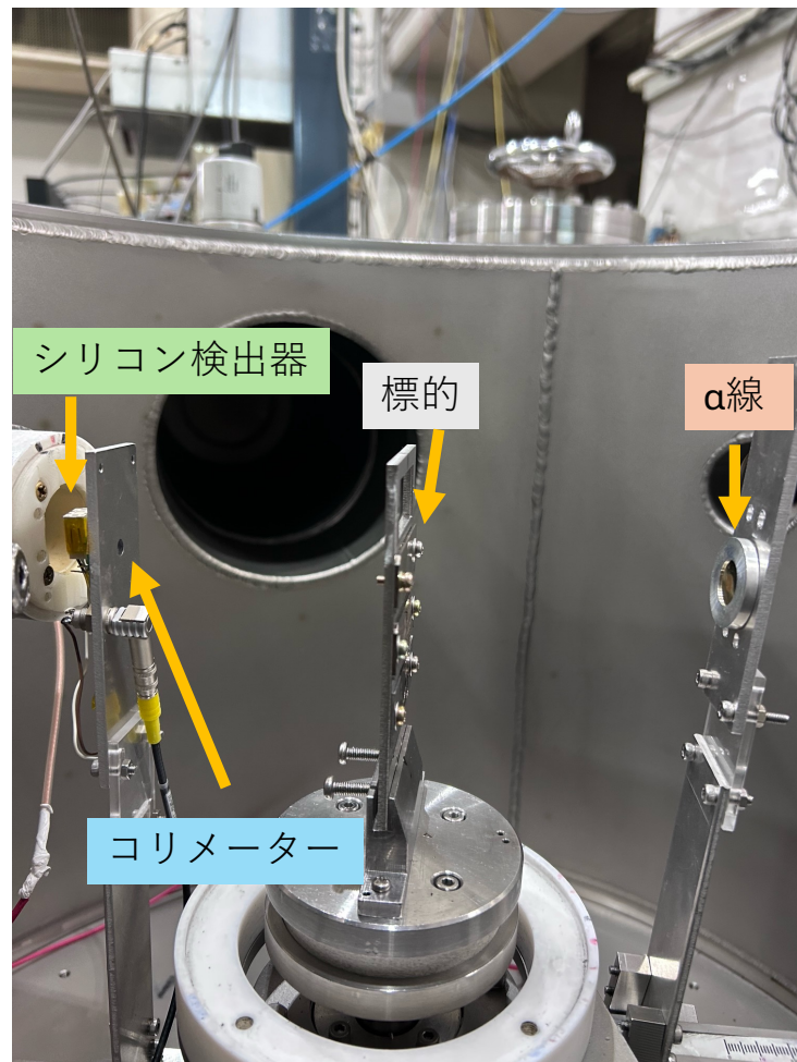
図 2.4: 標的厚さ測定の様子
