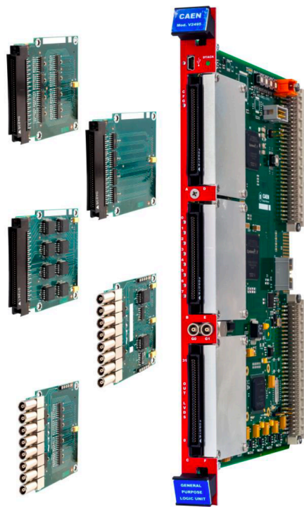
図 18 CAEN 社製ロジックユニット V2495 と各種の拡張モジュールの写真。文献 [24] から転載。
