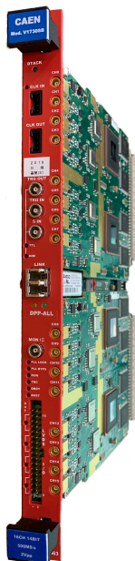
図 15 CAEN 社製 Flash Digitizer モジュール V1730 の写真
