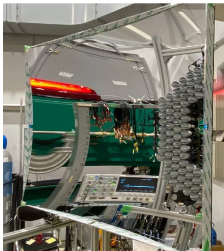
図 3.3: 使用した 1080 mm(水平) × 950 mm(垂直) の球面鏡の写真 (左) と固定具の模式図 (右)。
