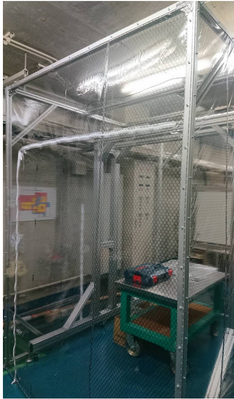
図5 MAIKo+ の開発作業用クリーンブースの写真。
