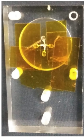
図 30 \alpha 線源のコリメータを正面から見た写真。図 31 \alpha 線源のコリメータを側面から見た写真。
