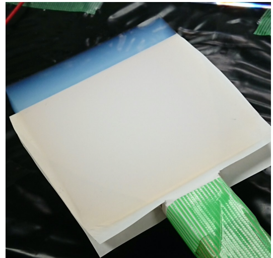
図 2.4: n = 1.007 (透過長 10 mm) のエアロゲルの写真。
