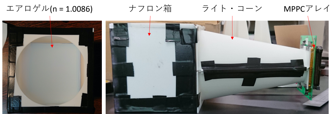
図 4.10: 集光用ライト・コーンを用いた試作 AC 検出器の写真。左の写真はナフロン箱にエアロゲルが入っている様子。右の写真は組み上げた試作 AC 検出器を横から見たものである。
