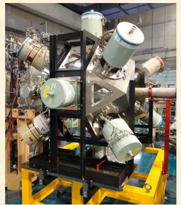
2015年3月 CAGRA(カグラ) ゲルマニウム検出器アレイ クローバー型Ge 12台 アメリカ、東北大学 +RCNP ENコース
